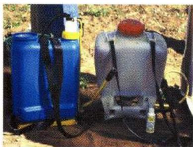
Las boquillas y el equipo en general deben ser calibrados cada vez que se van a utilizar; esto permitirá estimar la cantidad de agua y de insecticida que se utilizara.
